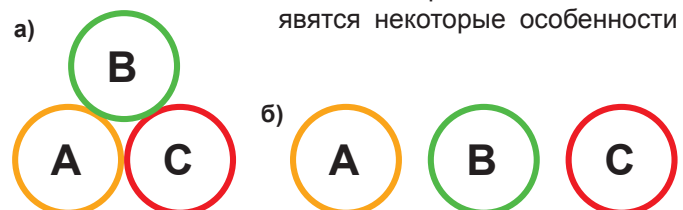
Рис. 1. Основные способы прокладки однофазных кабелей: а) сомкнутым треугольником; б) в ряд (в плоскости)
