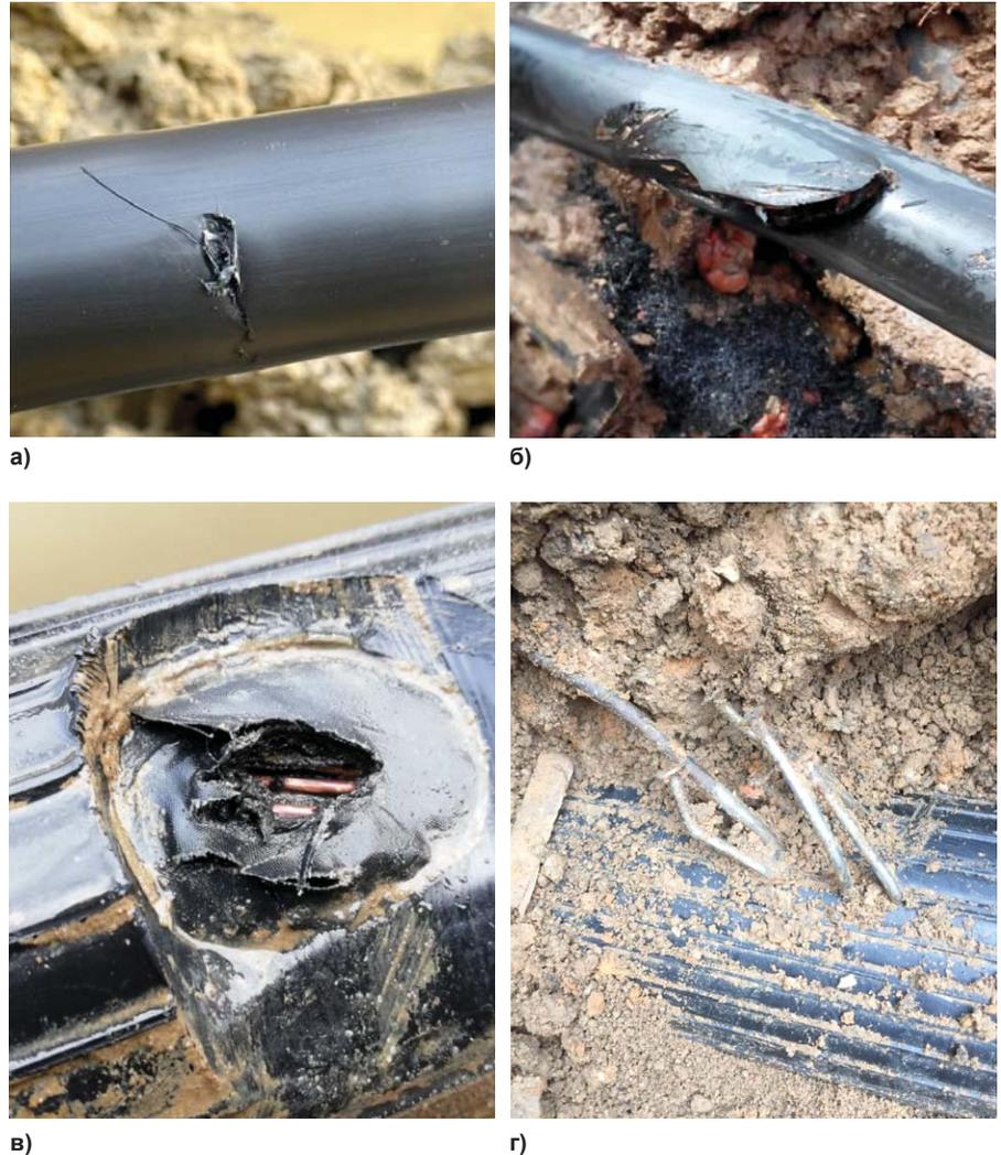
Рис. 3. Примеры повреждений оболочки: а, б) обычная оболочка; в, г) ребристая оболочка
