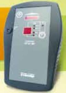
Предназначен для определения однофазного замыкания на землю (ОЗЗ) в распределительных сетях 6–10 кВ воздушных (кабельных) линий с изолированной нейтралью и локализации мест повреждения без отключения линии, что позволяет отказаться от метода кратковременных отключений фидеров подстанций и распределительных устройств.
