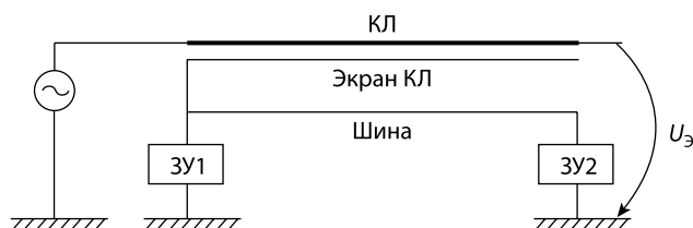
• Рис. 2. Схема заземления экранов кабелей и шины
