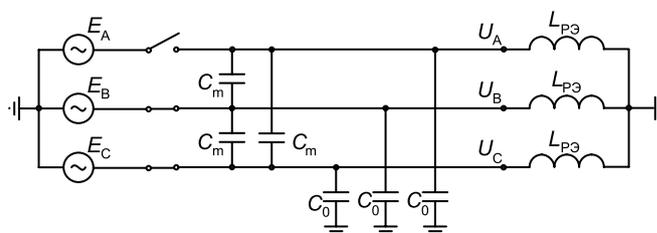
Схема для определения напряжения на отключенных фазах ВЛ при питании линии по одной фазе Рис. 4 ■
