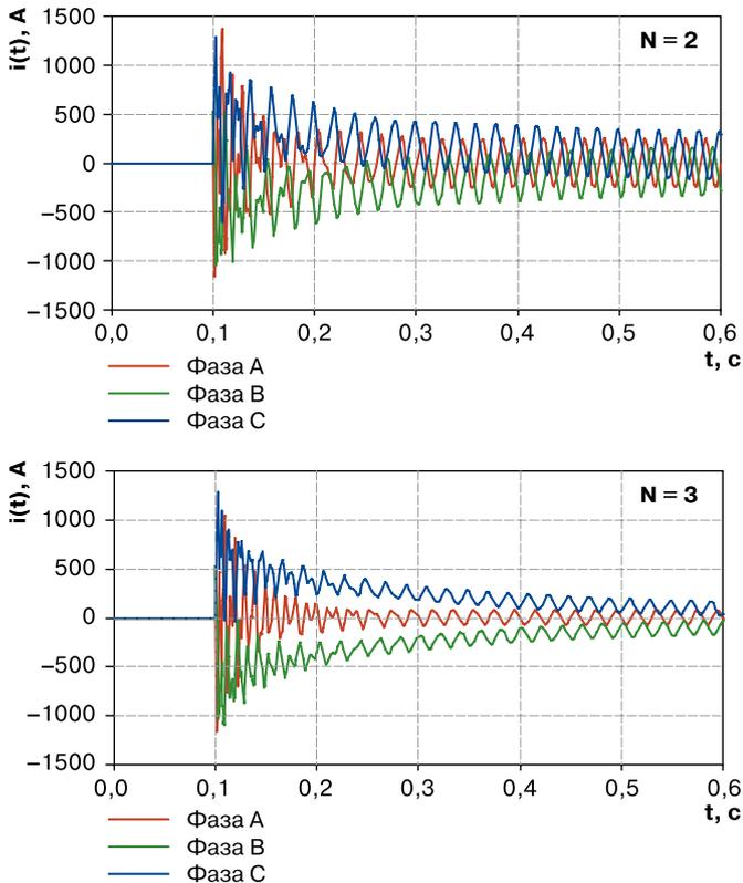
**Рис. 9.** Расчетные осциллограммы токов фаз выключателя В-504 на ПС «Кокшетауская» при его включении в условный момент времени 0,105 сек. К линии ВЛ-1102 присоединено  $N = 3$  шунтирующих реактора
