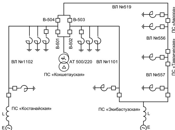
■ Рис. 2. Принципиальная схема электропередачи 1150 кВ
