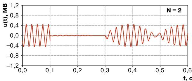
■ **Рис. 6.** Расчетная осциллограмма напряжения, воздействующего на продольную изоляцию выключателя В-504 на ПС «Кокшетауская» при успешном ОАПВ ВЛ-1102 при N = 2 присоединенных к линии реакторов
