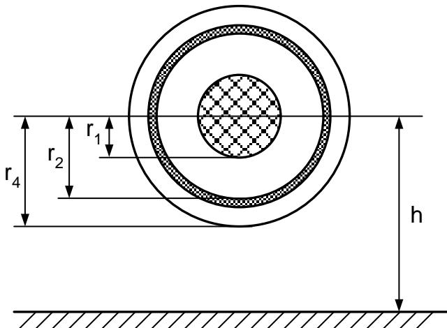
Рис.10.3. Однофазный кабель в качестве двухпроводной системы «жила-экран».
