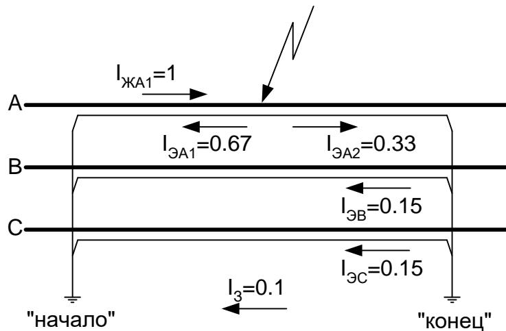
Рис.9.14. Результаты расчетов по формулам (9.4)-(9.7) при  $s/d = 1$  для кабеля 240/50  $\text{мм}^2$  при коротком замыкании в его середине  $L_{K1}/L_K = 0.5$ .
