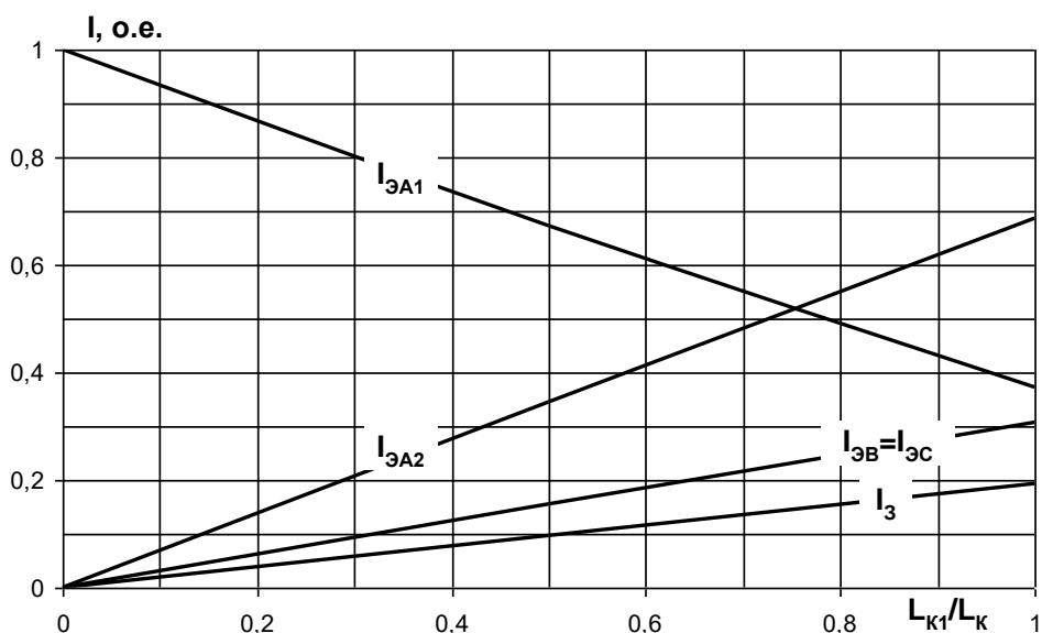
Рис.9.13. Результаты расчетов по формулам (9.4)-(9.7) при  $s/d = 1$  для кабеля 240/50 мм<sup>2</sup> в зависимости от соотношения  $L_{K1}/L_K$ .
