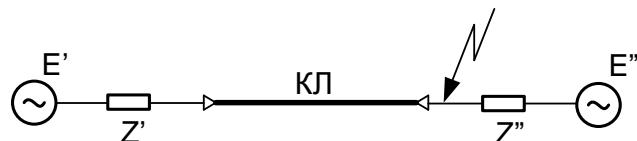
Рис.4.1. Расчетная схема сети, содержащей кабельную линию.
