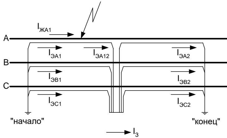
Рис.9.11. Близкое к «началу» кабеля повреждение изоляции «жила-экран» фазы «A» в группе из трех однофазных кабелей, экраны которых объединены в соединительной муфте.
