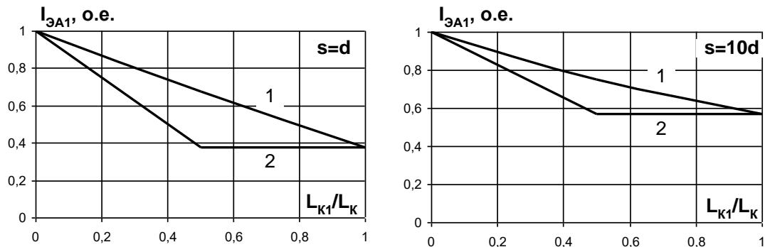
Рис.9.16. Оценка эффективности снижения тока в экране аварийной фазы за счет объединения экранов кабеля 240/50 мм<sup>2</sup> в соединительной муфте. Варьируются соотношения  $s/d$  и  $L_{K1}/L_K$ .
