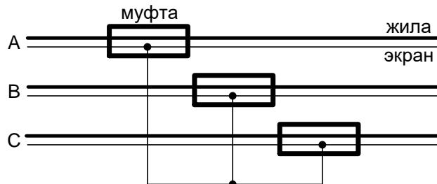
Рис.9.10. Объединение экранов однофазных кабелей в соединительных муфтах.
