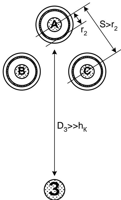
Рис.1.8. Группа из трех однофазных кабелей типа рис.1.1.
