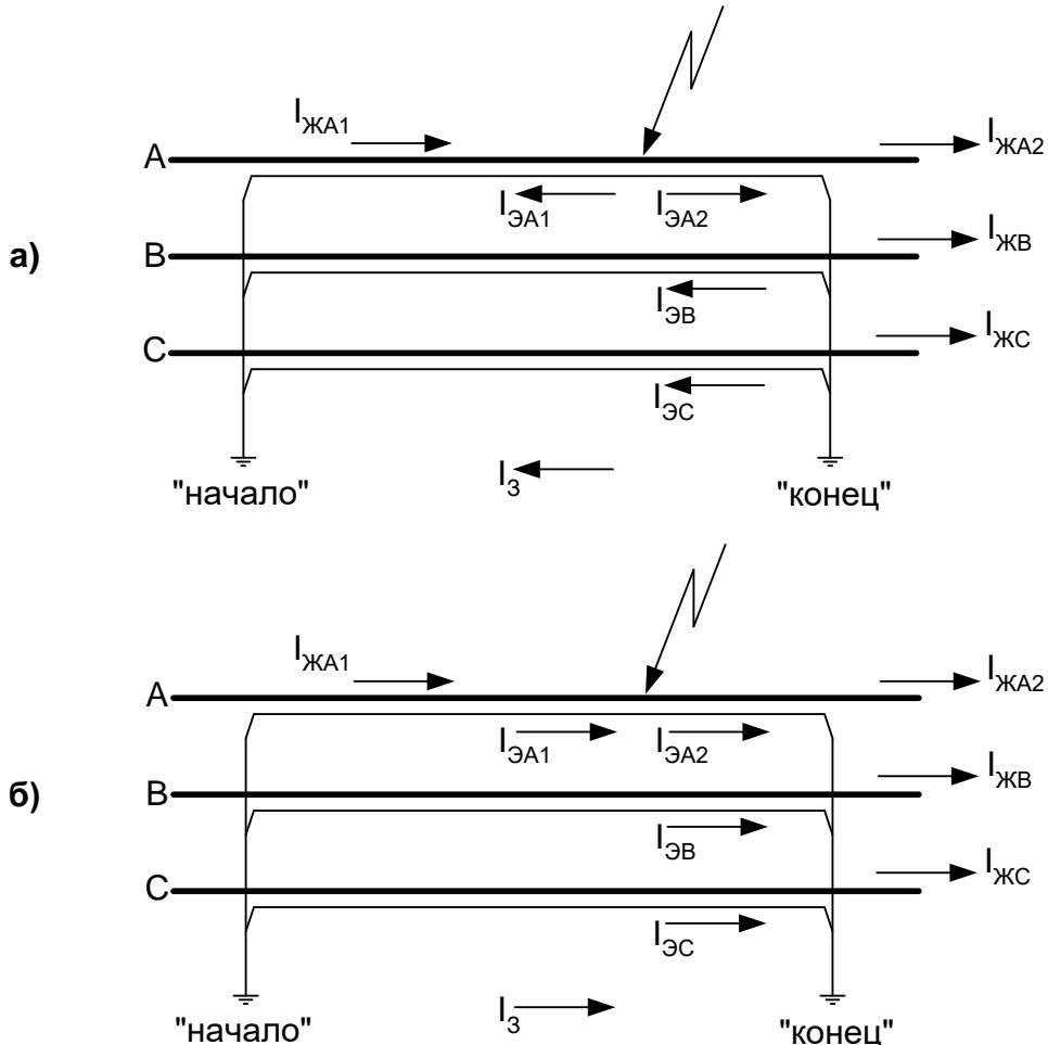
Рис.9.9. Повреждение изоляции «жила-экран» фазы «A» в группе из трех однофазных кабелей.
