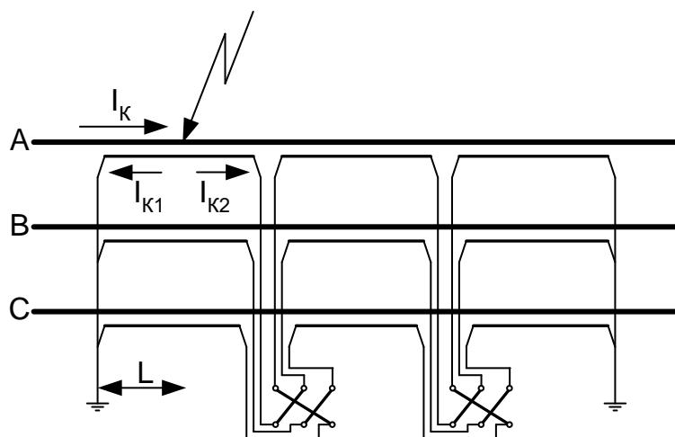
Рис.9.3. Повреждение изоляции кабеля, экраны которого заземлены по концам и применена транспозиция экранов.
