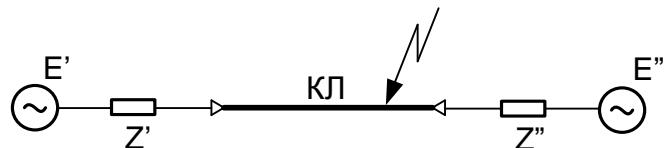
Рис.9.1. Расчетная схема сети, содержащей кабельную линию с поврежденной изоляцией.
