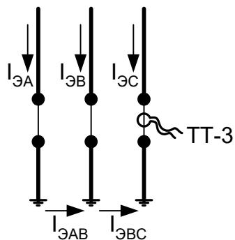
Рис.1.10. Заземление экранов на конце кабеля. Каждый экран присоединяется к заземляющему контуру своей шиной.
