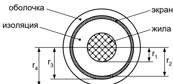
Рис.1.1. Однофазный кабель с изоляцией из сшитого полиэтилена.
