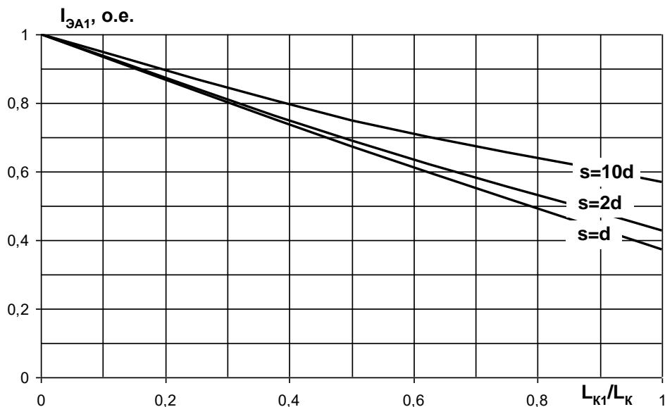
Рис.9.15. Результаты расчетов по формуле (9.6) для кабеля 240/50  $\text{мм}^2$  в зависимости от соотношения  $s/d$  и  $L_{K1}/L_K$ .
