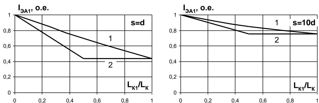
Рис.9.17. Оценка эффективности снижения тока в экране аварийной фазы за счет объединения экранов кабеля 500/95 мм<sup>2</sup> в соединительной муфте. Варьируются соотношения  $s/d$  и  $L_{K1}/L_K$ .
