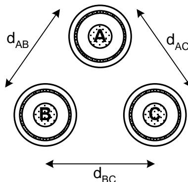
Рис.1.3. Расположение однофазных кабелей в вершинах равностороннего треугольника.
