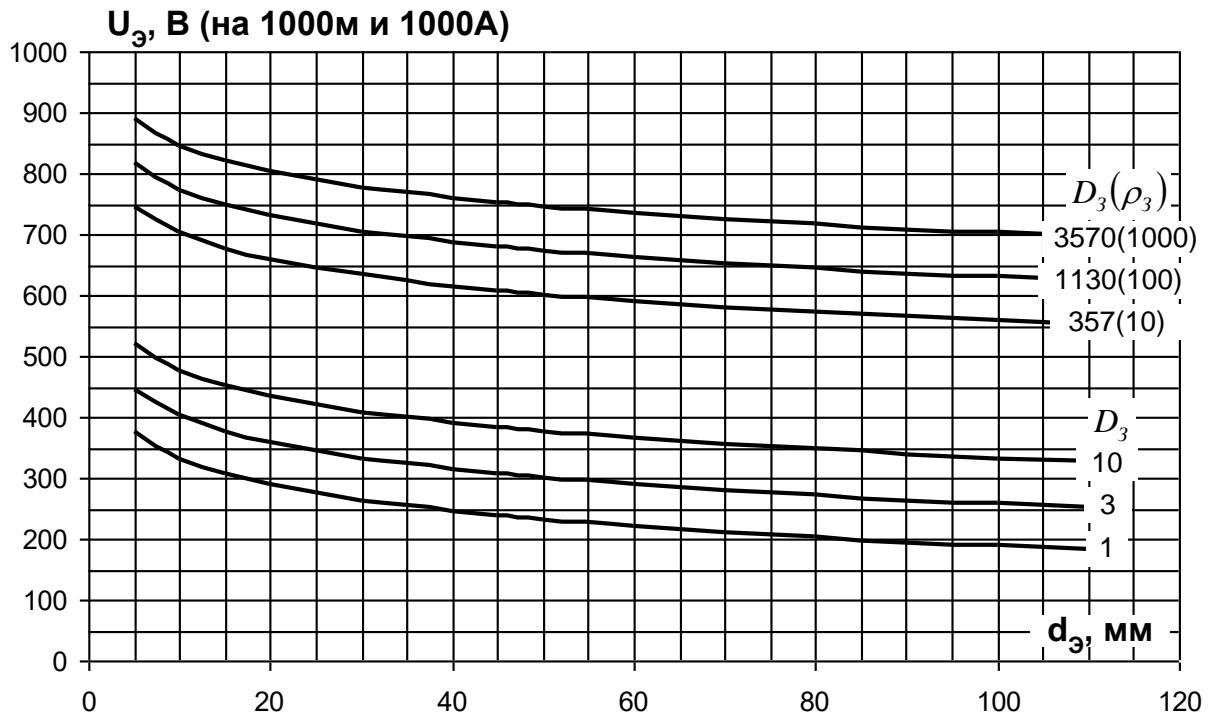
Рис.5.3. Напряжение на экране кабеля 6-500 кВ относительно земли, определенное по (5.3) для кабеля длиной 1000 м при токе жилы 1000 А в зависимости от диаметра  $d_3$  и глубины  $D_3$ .
