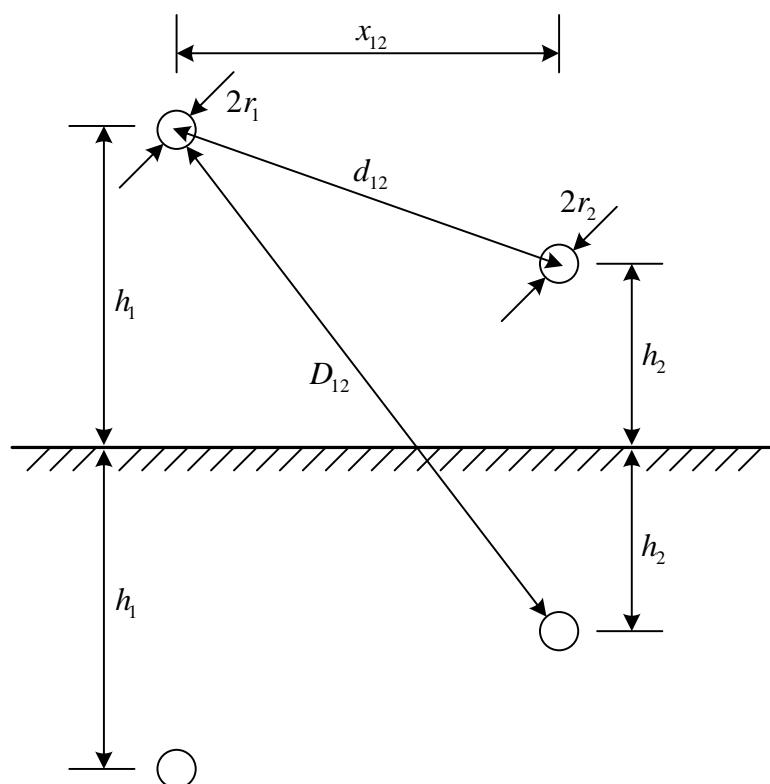
Рис.10.1. Провода и их зеркальные отражения (электрическое поле).
