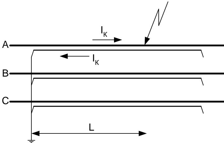
Рис.9.2. Повреждение изоляции кабеля, экраны которого частично разземлены.
