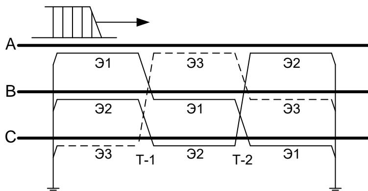
Рис.10.5. Напряжение на оболочке в случае транспозиции экранов.
