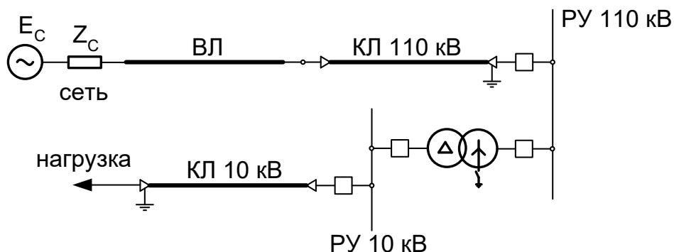
Рис.9.8. Рекомендации по одностороннему заземлению экранов в радиальной сети, основанные на анализе токов короткого замыкания.
