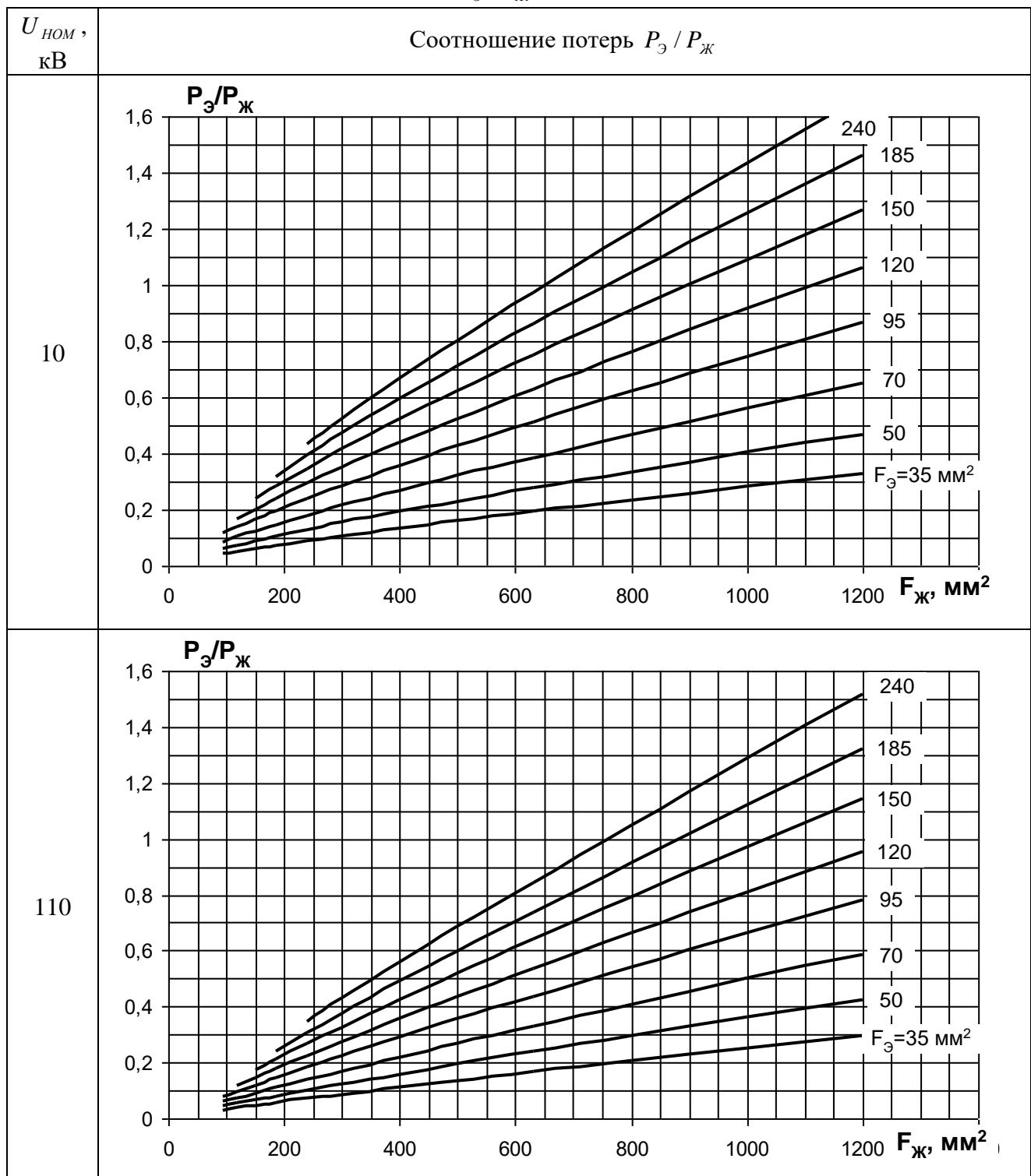
Рис.6.3. Коэффициент использования по току пропускной способности трехфазной группы однофазных кабелей 10 кВ, проложенных сомкнутым треугольником, в зависимости от сечения  $F_{ж}$  и материала жилы (Cu или Al), а также от сечения медного экрана  $F_{Э}$ .
