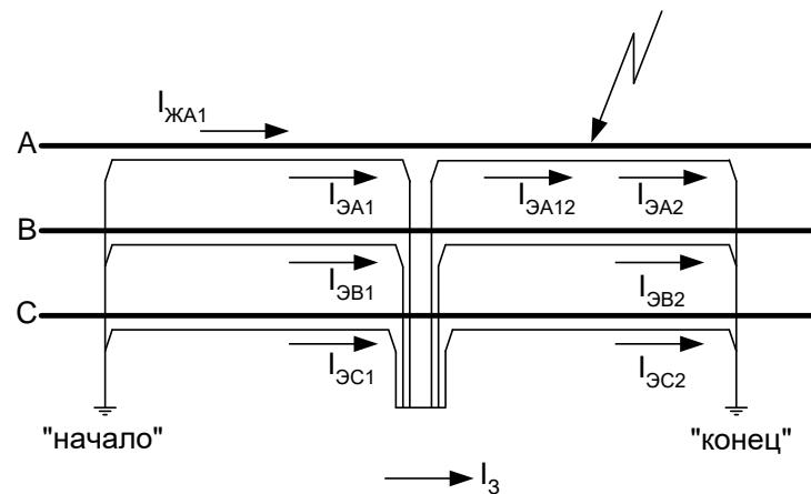
Рис.9.12. Близкое к «концу» кабеля повреждение изоляции «жила-экран» фазы «A» в группе из трех однофазных кабелей, экраны которых объединены в соединительной муфте.
