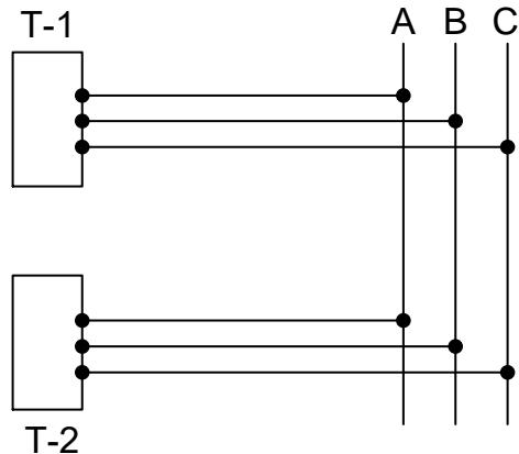
Рис.8.4. Соединение двух трансформаторов со сборными шинами по схеме «QxABC».
